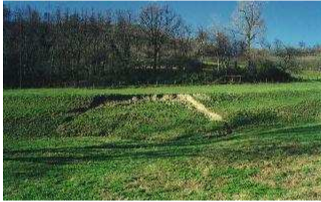
Dicembre 1994: soil slip in una valletta collinare, antropizzata ed adibita a prato-pascolo turnato.
